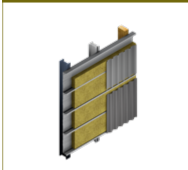
Profilwand mit Kassettenkonstruktion | siehe Seite 70
