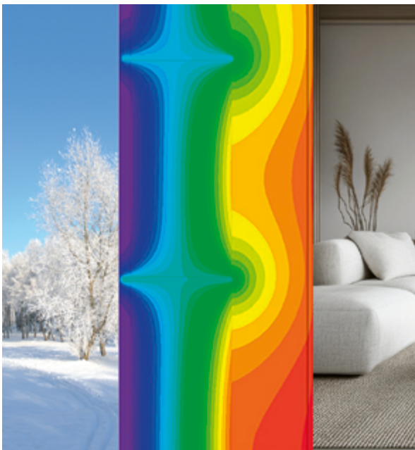
Abbildung 1 Ausgeprägte Wärmebrücke bei Aluminiumkonsolen
