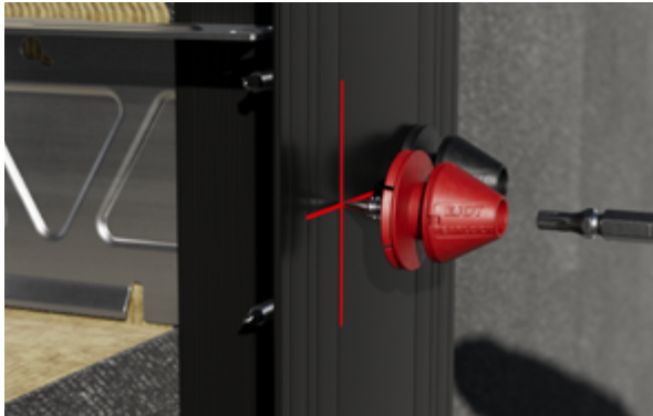
Das PEARLOCK® System auf der Aluminium- oder Stahlunterkonstruktion ausrichten und mit LT-TD-Schrauben mithilfe des verlängerten Bits TX25x70 verschrauben.
