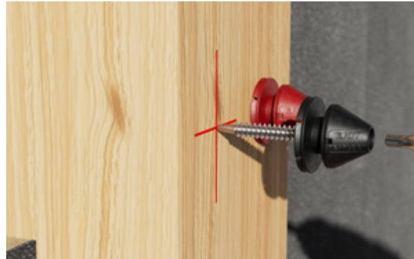
Das PEARLOCK® System auf der Holzunterkonstruktion ausrichten und mit der LT-XT-Schraube mithilfe des verlängerten Bits TX25x70 verschrauben.
