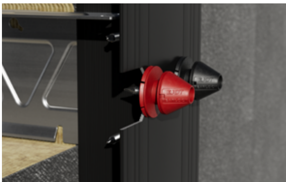
Die Festpunktvariante (rot) umschließt den Anschlagbund der Schraube vollständig und verhindert so die Relativbewegung. Sie sorgt für einen festen Sitz der Bekleidung. Die Gleitpunktvariante (schwarz) umfasst den Anschlagbund ebenfalls und zentriert ihn über einen Ring mit vier feinen Anbindestegen. Unter Querbelastung, etwa durch thermische Ausdehnung, reißen diese gezielt ab und ermöglichen eine kontrollierte Dilatation von bis zu 3 mm in jede Richtung.
