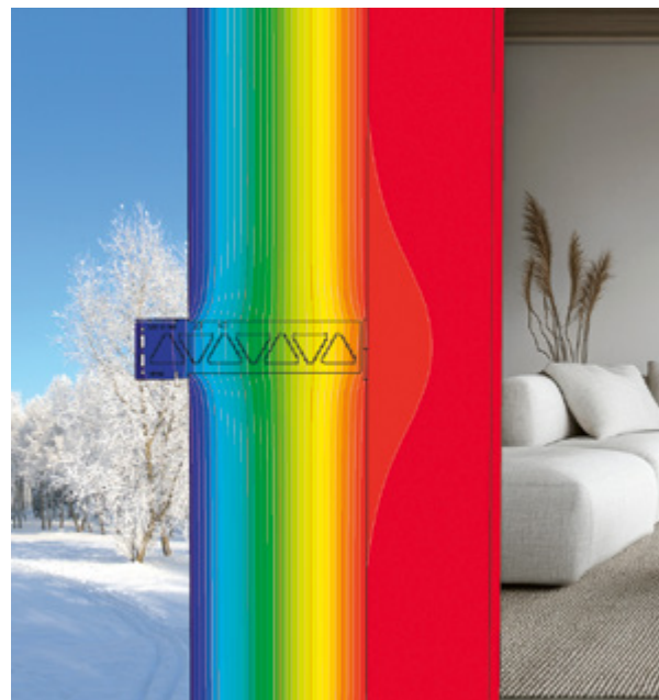
Abbildung 2 Minimale Wärmebrücke bei CROSSFIX®
