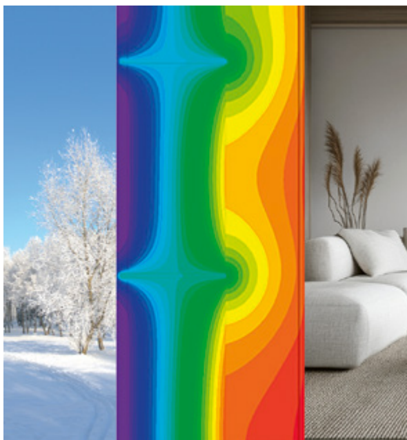
Abbildung 1 Ausgeprägte Wärmebrücke bei Aluminiumkonsolen
