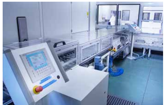
Industrielle Teilereinigungsanlage mit gekapselter Rollenbahn für den Transport feinstgereinigter Ware in den Reinraum
