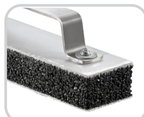
EPP-Schaum + PP GF-Deck- schicht Auszugskraft 500-900 N
