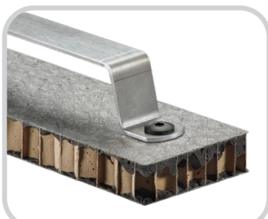
Papierwabe + PUR GF-Deck- schicht Auszugskraft 900 N
