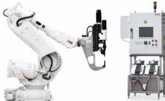
Setzgerät mit C2 Bügel und optionalem 2. Förderer
