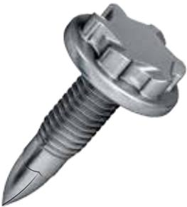
Die fließlochformende EJOT FDS® Schraube ermöglicht eine höherfeste Verbindung, bedingt durch einen hohen Gewindetrageanteil im geformten Durchzug, sowohl bei Stahlblech- als auch bei Aluminium-Anwendungen.
