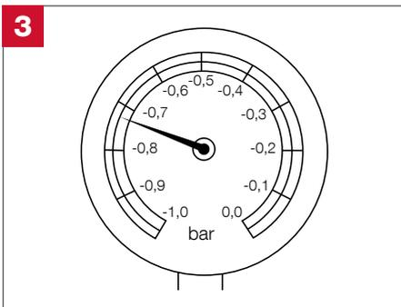
Unter der Voraussetzung, dass der Saugdruck konstant bleibt, ist die Baugruppe dann luft- und wasserdicht.
