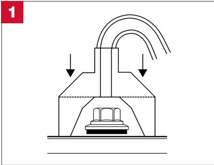
Setzen Sie das Mundstück über den Befestiger und stellen Sie mit leichtem Druck sicher, dass eine erste Abdichtung erreicht wird. Achten Sie auf eine glatte und luftdichte Oberfläche.
